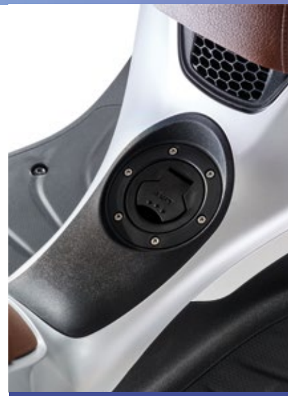
ΤΑΠΑ ΡΕΖΕΡΒΟΥΑΡ ΚΑΥΣΙΜΟΥ ΣΤΟ ΚΕΝΤΡΙΚΟ ΤΟΥΝΕΛ
